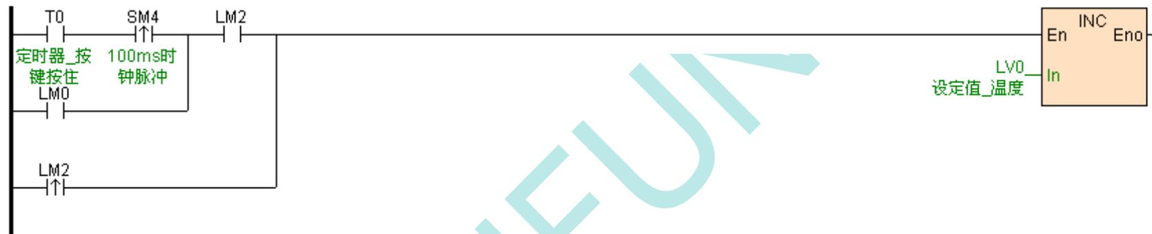
//Network 3 使用按键：设定值减少 按住F1设定键，同时点动DN键可细调减少温度设定值；按住F1设定键，同时按住DN键不放，两秒钟以后温度设定值呈中速减少；按住F1设定键，同时按住F2加速键和DN键，温度设定值呈快速减少
