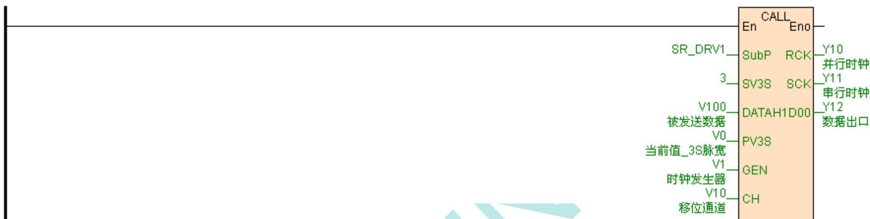
//Network 2 调用按键操作子程序：SR\_BUTT 按下设定键，发送温度设定值
